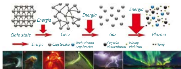
Rys. 1 Wytwarzanie plazmy. Etapy przejścia ze stanu stałego przez ciecz po gaz do plazmy, z uwzględnieniem oddziaływania energii na każdym z etapów Źródło: [1]
